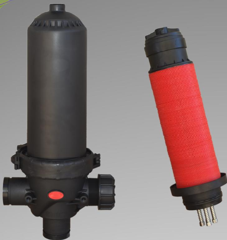
C'est un filtre à disque autonettoyant en simple corps 3". Le processus de contre lavage se fait par écoulement en sens inverse sur les rainures des disques après leurs séparation hydraulique à l'aide de deux pistons en inox situé en bas de chaque cartouche .
