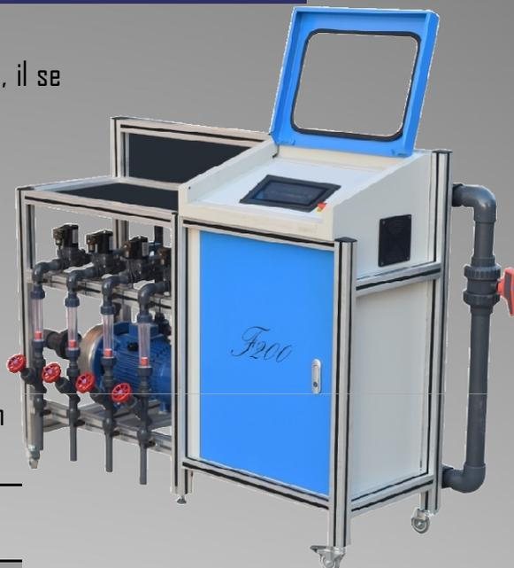
✓ Chaque ligne est constituée principalement d'un **injecteur Venturi 3/4"** associé à son aspiration à des **vannes à diaphragmes** ; des **débitmètre à flotteur en plastique** pour régulation et lecture de débit injecté ; et des **électrovannes** en plastique résistantes à la corrosion .
